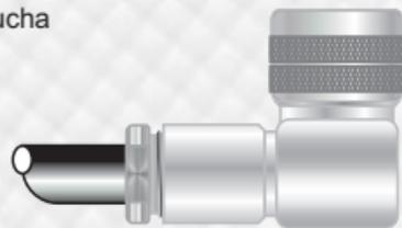
Introduza a parte montada no conector. Solde o condutor central ao pino. E com o auxílio de uma chave fixa de 5/8", rosqueie a porca redutora e dê o aperto final
