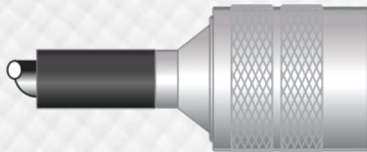
5 - Encaixe o corpo do conector no cabo montado entre o condutor externo e o dielétrico, arraste a bucha crimp até encostar no corpo e crimpe-a, logo cubra com termo retrátil e aqueça até fixa-la.
