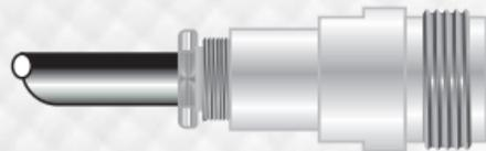
Introduza a ponta montada no conector. Rosqueie a porca redutora ao corpo do conector com auxílio de uma chave fixa de 14 mm e uma de 3/8" dê o aperto final. Este aperto deve ser o suficiente para travar o cabo
