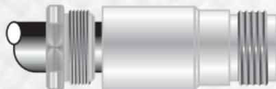
Introduza a ponta montada no conector. Rosqueie a porca redutora ao corpo com auxílio de uma chave fixa de 11/16" e uma de 5/8". Dê o aperto final (este aperto deve ser o suficiente para travar o cabo).
