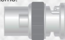
4 - Introduza o cabo montado pela traseira do corpo montado.
