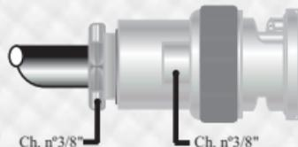
5 - Para finalizar a montagem introduza o cabo no corpo montado, rosqueie a porca sextavada e dê o aperto final com o auxílio de duas chaves fixas nº 3/8".
